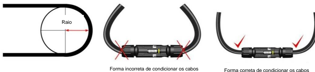
Figura 5. O roteamento correto e o raio de curvatura mínimo dos cabos.
